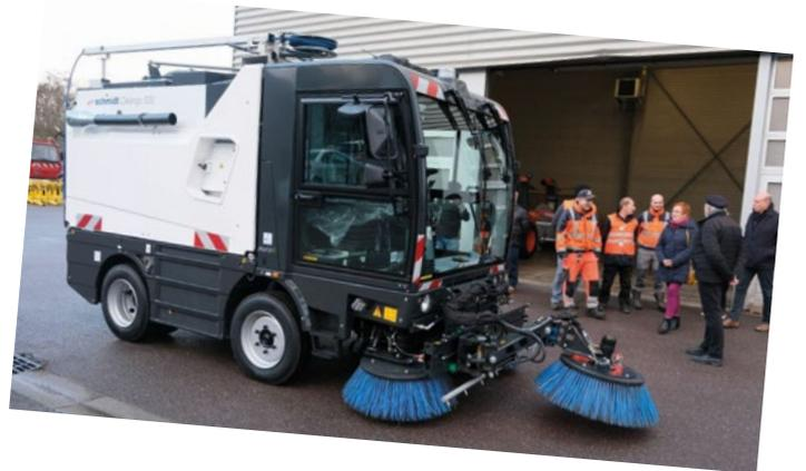
De dernière génération, le véhicule permet de nettoyer et désherber rapidement et efficacement les caniveaux, les trottoirs et la route, au moyen de brosses mais aussi d'un bras mécanique. De plus, elle dispose d'un aspirateur, d'un système «haute pression» et de brosses réglables en fonction du sol. Elle est également moins bruyante et consomme moins de carburant.
